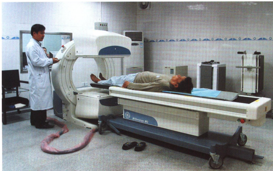
上图：全省目前最先进的GE公司生产的双探头单光子发射型计算机断层显像仪—Millennium MG型核素成像仪，附院核医学科人员正在为患者进行全身骨显像检查
